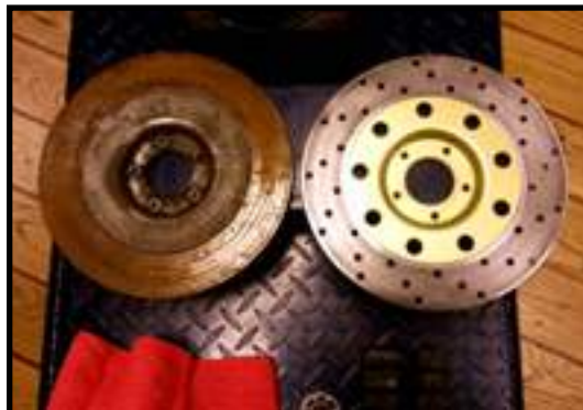
Her er bremseskiva gjennomgått en forvandling, bremsene foran ble byttet ut med større skive og kraftigere caliper.
