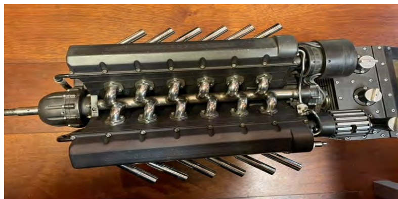
En komplett og fullt ut funksjonell Rolls Royce Merlin V12 i miniformat
